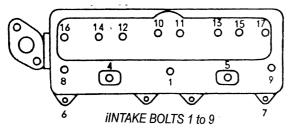
CYLINDER HEAD BOLT TIGHTENING SEQUENCE
