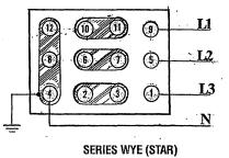
L-L-450 VAC 3Ø 60 HZ L-N-265 VAC 1Ø 60 HZ
